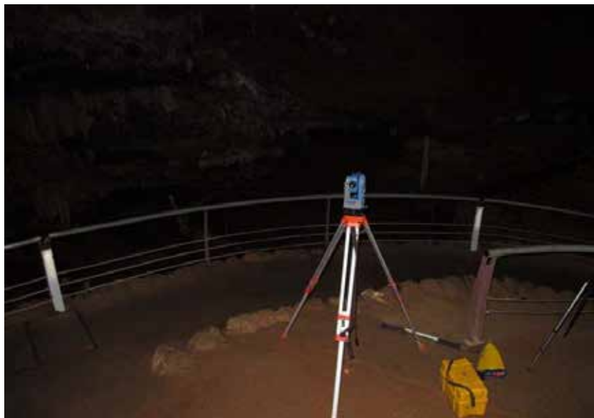
Figura 2. Detalle de la estación total Zeiss ELTA-R con la que se ha realizado el levantamiento topográfico de la cavidad, de las secciones transversales y de la sección longitudinal.
