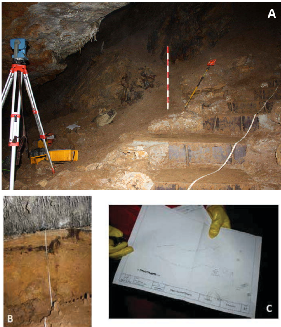
Figura 6. En la imagen 6 A y B se observa como la cinta métrica se dispone perpendicular a la dirección principal de la cueva para tomar detalladamente los datos espaciales de cada transecto. En la imagen se aprecia uno de los planos con el contorno de la sección para su posterior cartografía.
